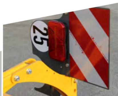
L'équipement de la machine, tel qu'un système de verrouillage des extensions grâce à des loquets à commande hydraulique, est complété par un **éclairage routier à LED**, pour une circulation sur route en toute sécurité.
