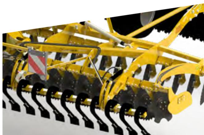
Le kit **Cross-Board frontal**, à réglage hydraulique, permet de niveler le sol avant le passage des disques, et d'enfoncer les mottes pour plus d'efficacité en reprise de labour et préparation du lit de semence.
