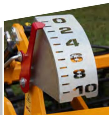
Le réglage de la profondeur de travail, à commande hydraulique, peut s'ajuster en continu depuis le poste de conduite.
