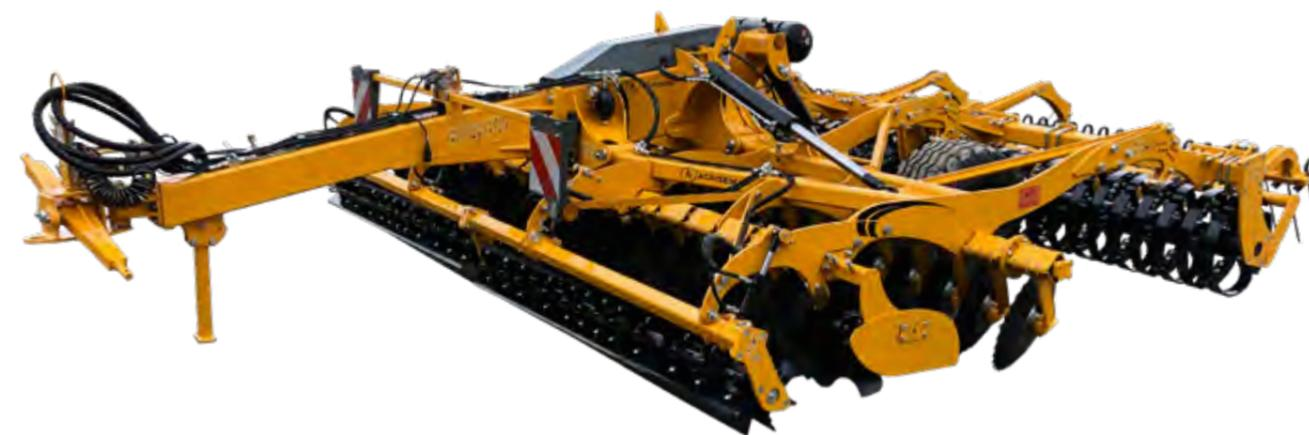
Pour augmenter la capacité de broyage et de destruction des couverts végétaux et des chaumes de colza ou tournesol par exemple, le kit **rouleau cutter frontal** est proposé en option. Equipé de lames en acier trempé et affûtées, un système de pression hydraulique assure un **suivi du sol** et une **pression régulière**. Il permet aussi de renforcer le défibrage des cannes de maïs, pour lutter contre les ravageurs tels que la pyrale et la sésamie.
