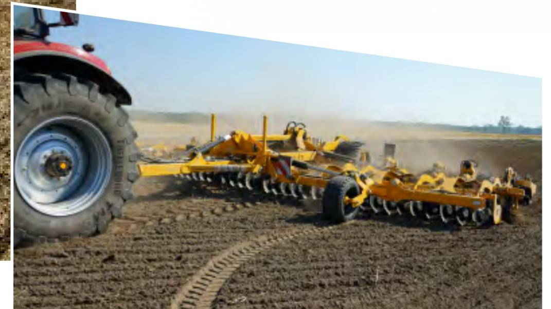
Pour un excellent suivi de la profondeur de travail, le Disc-O-Mulch est équipé d'un **contrôle à réglage hydraulique** sur les roues avant et sur le rouleau. La cinématique de repliement de châssis flottante permet une adaptation au relief du terrain pour un travail régulier.
