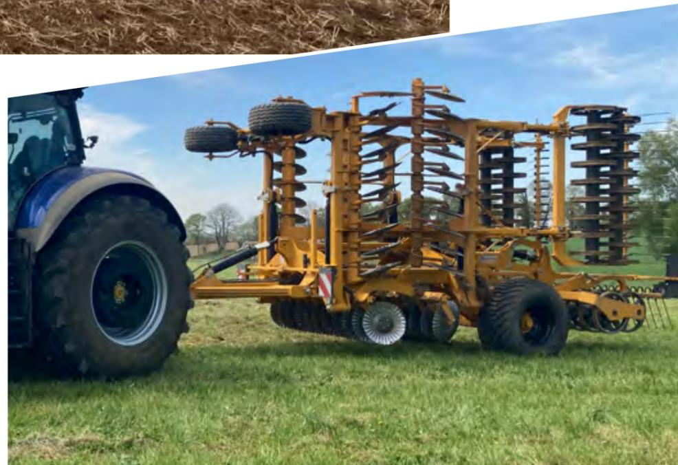
Le Disc-O-Mulch est équipé de roues avant de grandes dimensions, qui participent au contrôle de la profondeur de travail qui est ajustée hydrauliquement.
