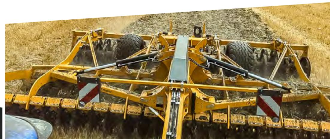
L'essieu de transport est positionné entre la seconde rangée de disques et le rouleau.
