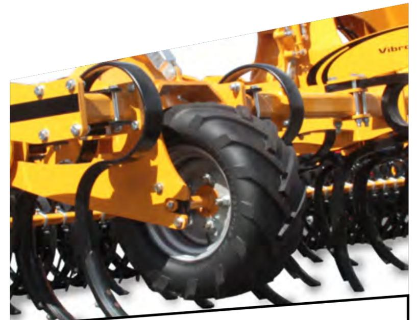
En option, le Vibromulch peut être équipé de 2 roues stabilisatrices à l'avant qui **assure une précision de profondeur de travail** même à grande vitesse et en conditions difficiles.
