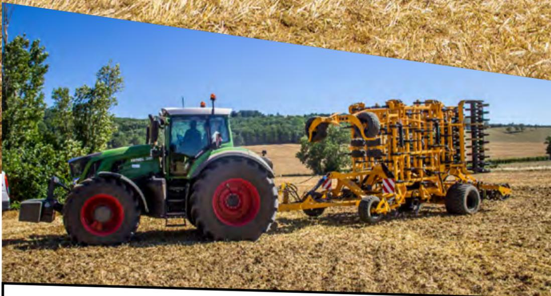
Au transport, le Vibromulch reste compact avec un gabarit inférieur à 3 m de largeur et 4 m de hauteur.
