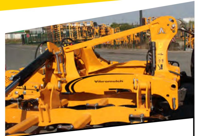
La structure est assurée par **un châssis robuste** dont la rigidité au travail est renforcée par la cinématique des 2 vérins de repliage qui ont un maintien sur l'extérieur du châssis.
