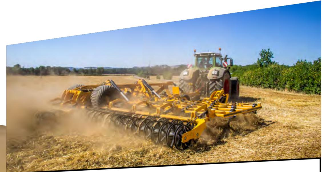
Au travail la machine est contrôlée par le rouleau et les roues de support à l'avant, placées sur le châssis central ainsi que sur les extensions pour **assurer un meilleur suivi du terrain.** La profondeur de travail peut s'ajuster hydrauliquement en continu depuis le poste de conduite.
