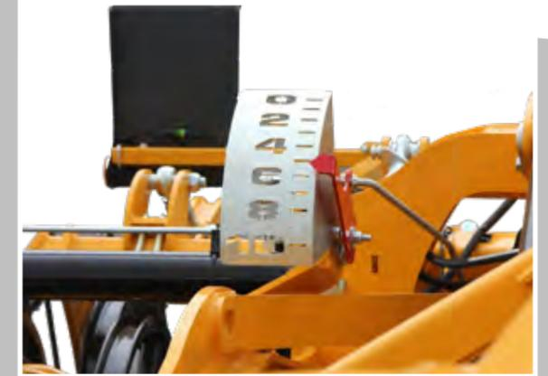
Les manœuvres en fourrières sont effectuées en tournant sur l'essieu situé entre la 4<sup>ème</sup> et la 5<sup>ème</sup> rangée de dents, ce qui permet **un gabarit compact et une grande maniabilité**.
