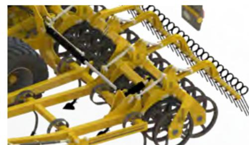
Le kit de **Cross-Board** frontal à réglage hydraulique, disponible sur l'ensemble de la gamme Vibromulch, permet de **nivelier le sol** avant le passage des dents et d'**enfoncer les mottes** pour plus d'efficacité en reprise de labour et **préparation du lit de semence**.
