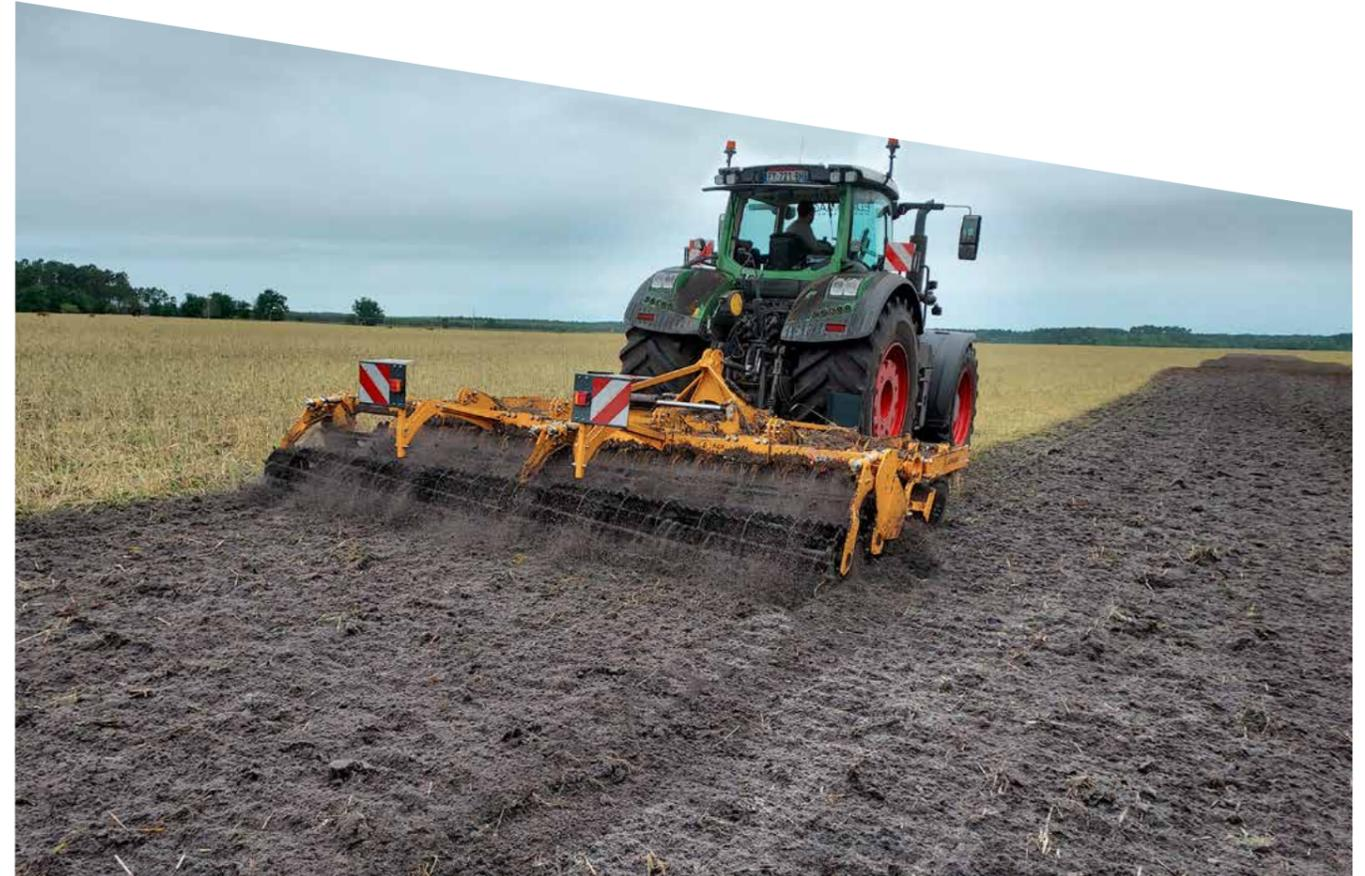
La gamme portée est composée de 3 modèles fixes de 3,00 m – 3,50 m et 4,00 m (destinés à des tracteurs de 75 à 180 ch) et de 3 modèles repliables de 4,00 m – 4,50 m et 5,00 m (destinés à des tracteurs de 110 à 220 ch).
