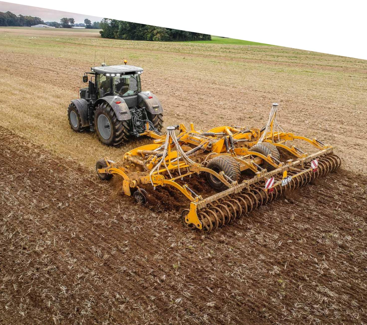
Equipé de roues de contrôle avant et de rouleaux directement reliés au châssis, le Disc-O-Mulch assure un suivi précis de la profondeur de travail sur toute la largeur, autorisant notamment l'utilisation pour le semis ou le déchaumage superficiel.
