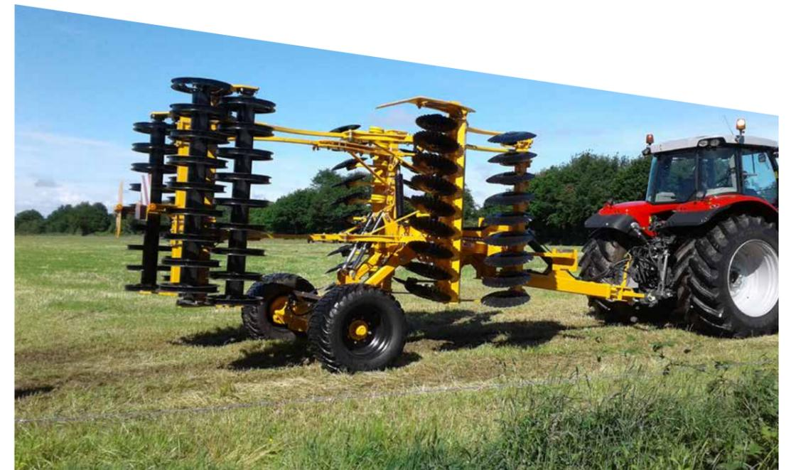
AGRISEM a fait le choix, lors de la conception du Disc-O-Mulch Gold traîné, de positionner l'essieu de la machine entre la seconde rangée de disques et le rouleau.
