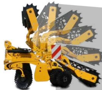
Un système optionnel de **repliage hydraulique** du rouleau, réduisant le porte-à-faux, sécurise le transport sur route. Cela autorise notamment le montage avec un rouleau assurant un fort rappui.
