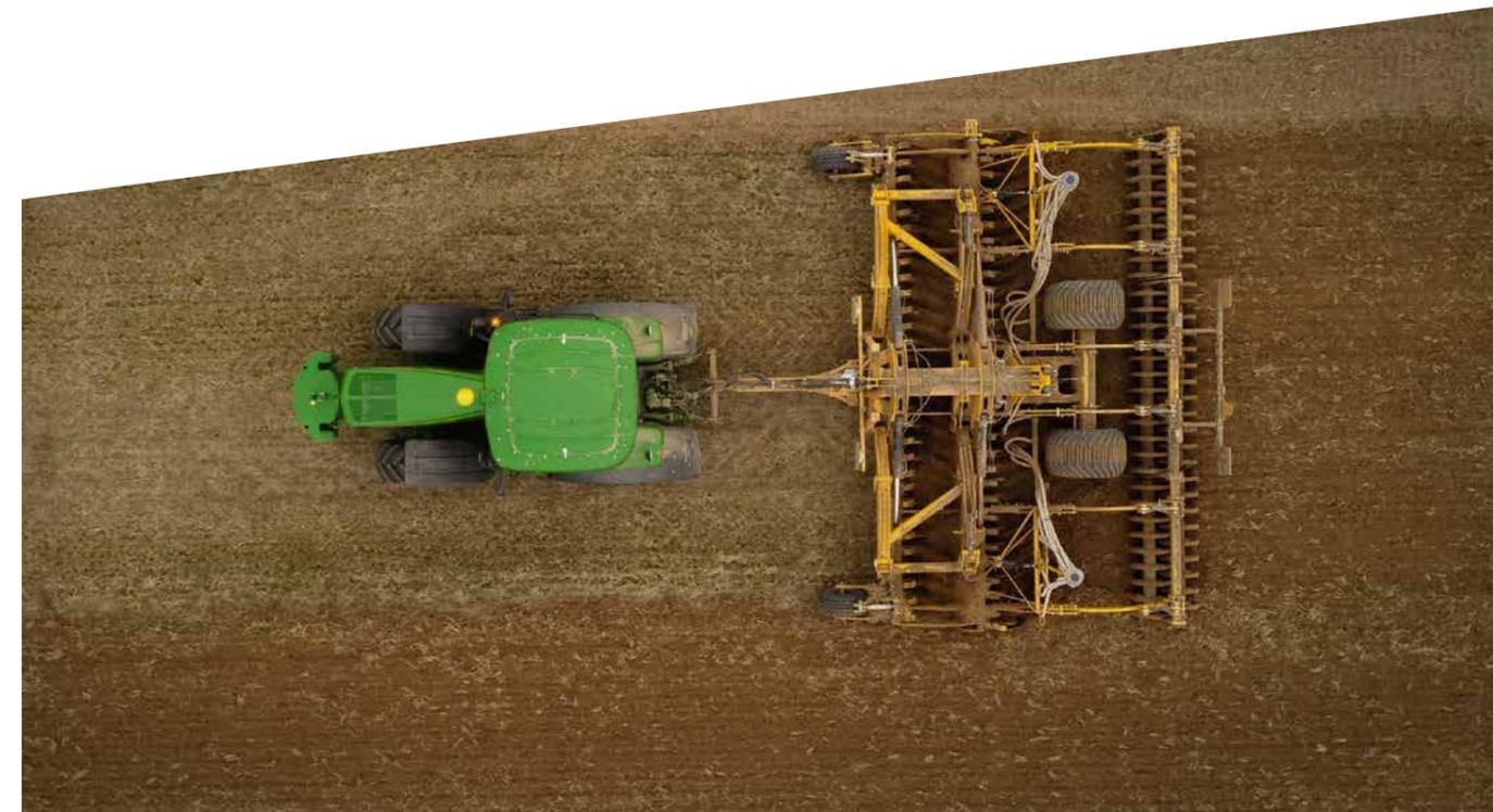
Le Disc-O-Mulch Gold traîné 7,50 m – 8,00 m et 9,00 m est conçu pour des tracteurs de 250 à 420 ch. Il permet un débit de chantier important, tout en conservant un gabarit compact.
