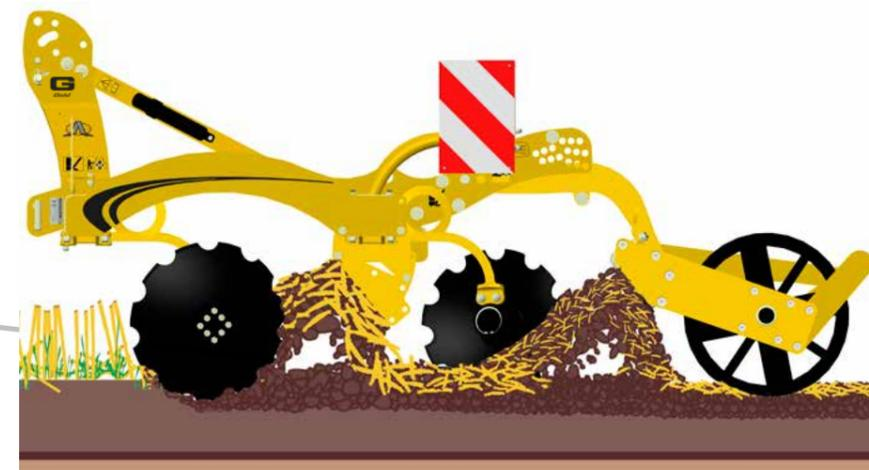
Les deux rangées de disques du Disc-O-Mulch Gold sont pourvues de disques de plus grand diamètre à l'avant (610 mm), et plus petits à l'arrière (560 mm de série).
