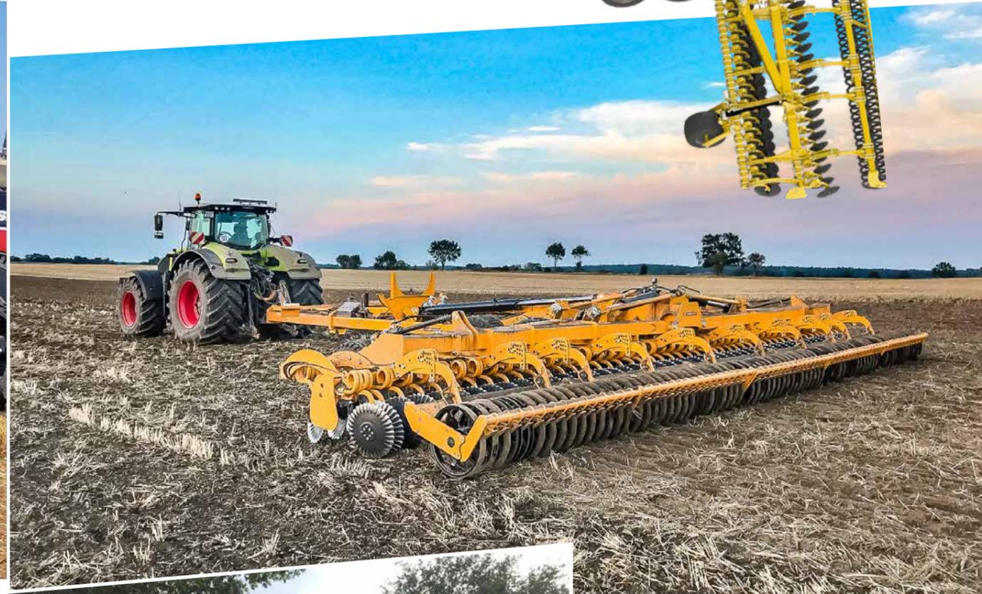
Encore plus de dégagement entre les rangées de disques avec la version EXTRA (+170 mm), ainsi qu'entre les disques (pas de 285 mm) pour les utilisations même en conditions humides avec beaucoup de résidus.
