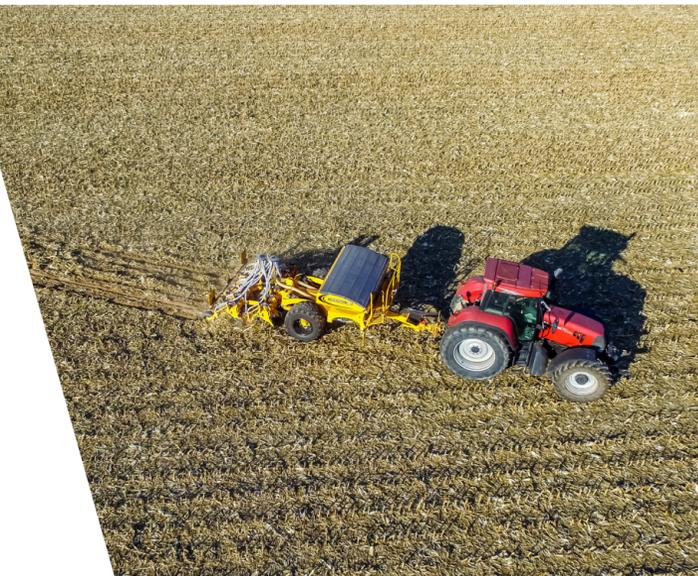
AGRISEM a développé un semoir à dents droites qui peut être associé à une trémie frontale DSF dont la capacité peut varier de 1600 à 2200 litres.
