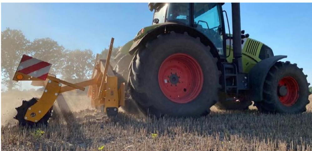
Avec un rouleau pour le contrôle de profondeur et le rappui.
