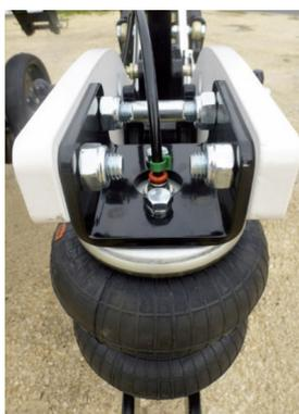
**Poumons pneumatiques** permettent d'ajuster la pression sur le parallélogramme et sur le rouleau arrière depuis la cabine.
