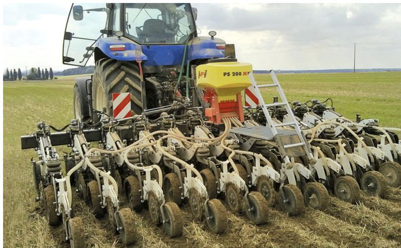
12 rangs à 45 cm avec éléments de semis pour semis du colza
