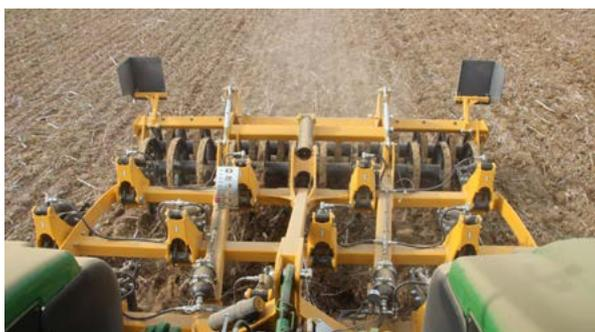
L'aileron, incliné vers l'avant soulève progressivement le sol avec un « effet de vague ».
