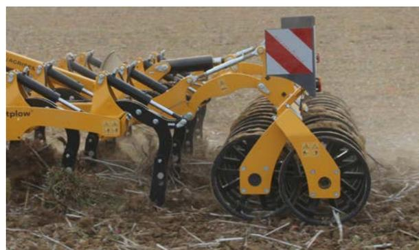
Le gabarit compact de la machine autorise le montage de rouleaux doubles. De plus, la cinématique de parallélogramme à tirants permet d'appuyer différemment les rouleaux pour viser à obtenir un profil nivelé ou plus ouvert en billons.
