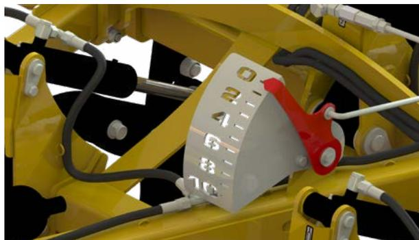
Grâce au réglage hydraulique de profondeur en continu depuis le poste de conduite, il est facile d'adapter la profondeur de travail aux différentes zones dans la parcelle.
