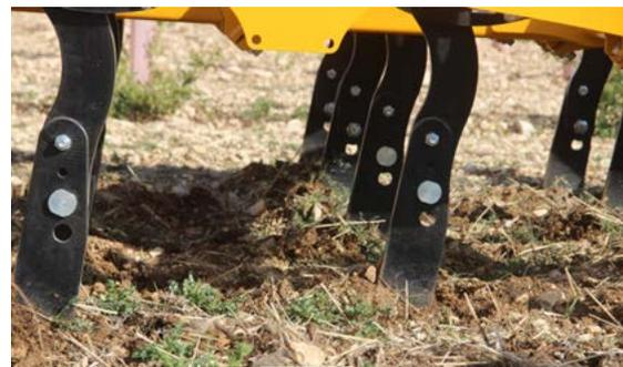
Le SMARTPLOW est équipé de lames à pointe décalée 20x590, qui ont hérité du principe de la lame TCS, développée et brevetée par AGRISEM, qui a fait la renommée des ameublisseurs de la marque.
