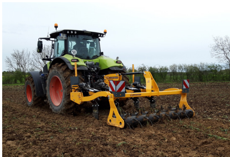
Cultiplow Platinum HD 3 m - 4 lames Sécurité boulon - rouleau Combimulch Steel-Pack
