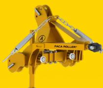
Système d'attelage auto-directionnel sur le modèle frontal, assurant une liberté de guidage par le tracteur
