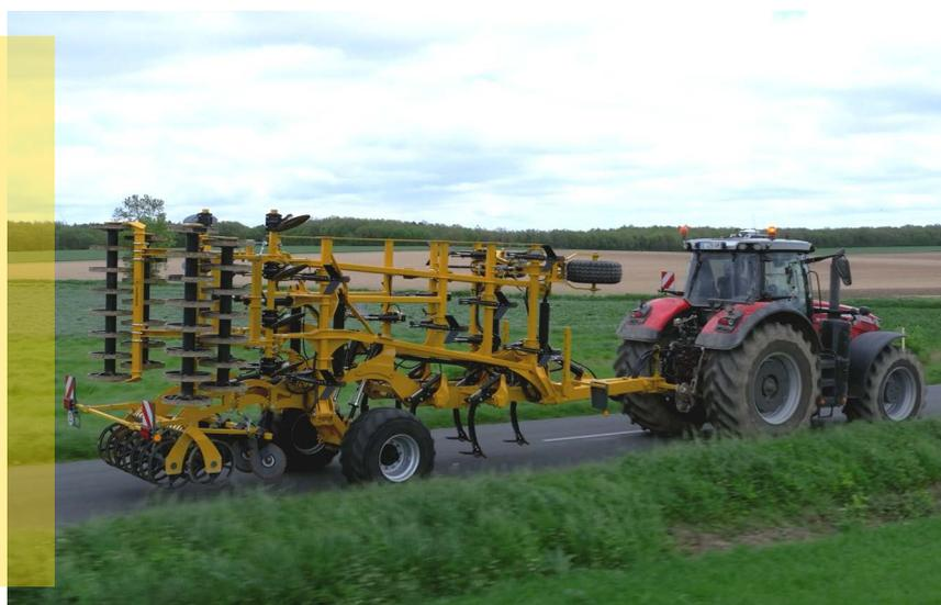
Il est également possible d'équiper la machine d'une rangée de coutres circulaires frontales. Cela permet de découper les résidus les plus longs et repousser ainsi les limites d'utilisation de la machine.
