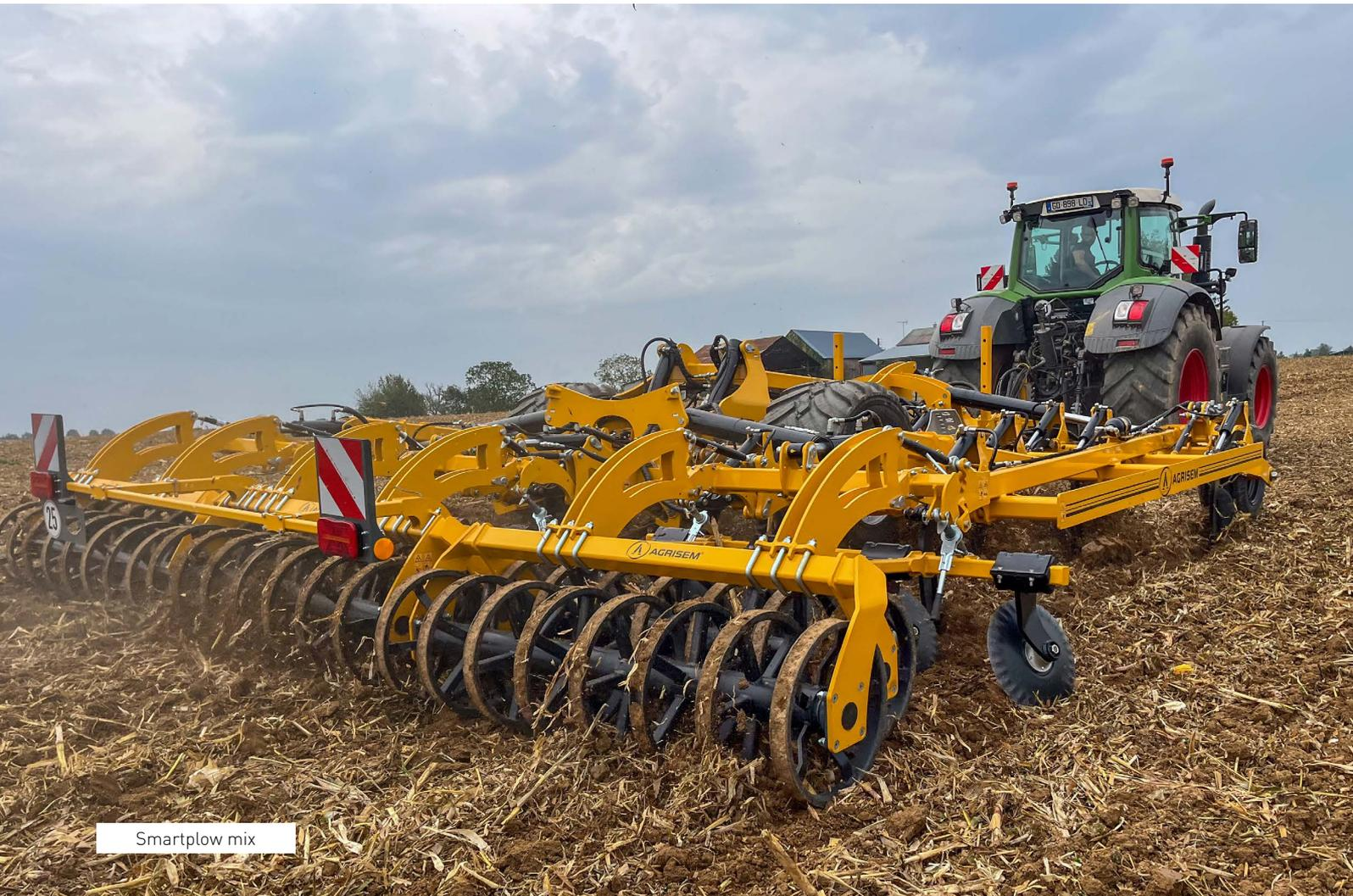
Décliné en trois largeurs 6-7,50 et 8m, le Smartplow traîné se destine aux tracteurs de forte puissance (de 250 à 480ch), et aux grandes exploitations en recherche de performance grâce à son débit de chantier et son dégagement assuré par le montage des dents sur 4 rangées.
