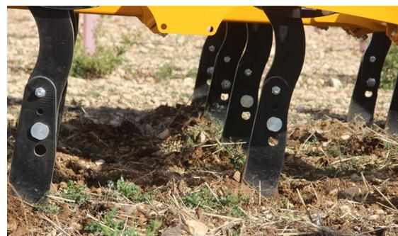
Le SMARTPLOW est équipé de lames à pointe décalée 20x590, qui ont hérité du principe de la lame TCS, développée et brevetée par AGRISEM, qui a fait la renommée des ameublisseurs de la marque.
