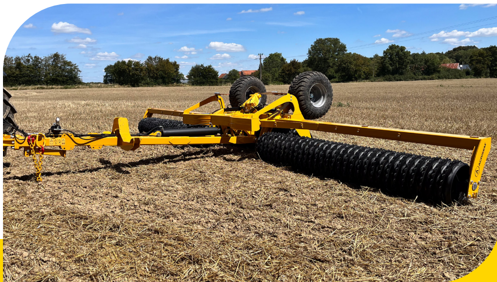
Attelage sur bras de relevage du tracteur cat.3
