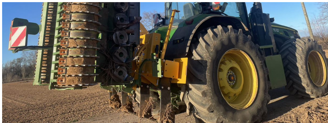
En s'intercalant devant un outil pour corriger la compaction des tracteurs de fortes puissances.
