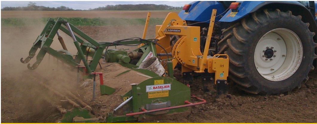
Avec une fraise rotative pour la préparation des pommes de terre.
